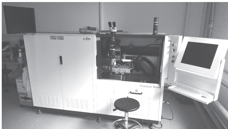
Рис. 5. Система прецизионной лазерной резки стентов StarCut Tube Fiber
